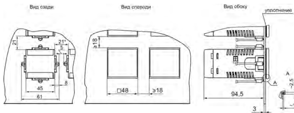
Рисунок 4.9 – Прибор в корпусе Щ5, установленный в щит толщиной 3 мм
