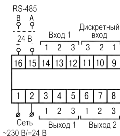
Рисунок 5.5 – Общая схема подключения ТРМ10–Щ5
