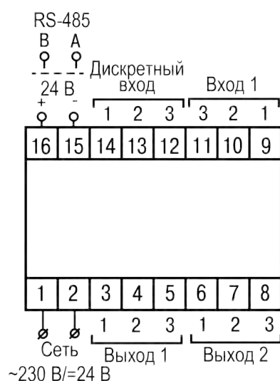
Рисунок 5.6 – Общая схема подключения ТРМ10–Д
