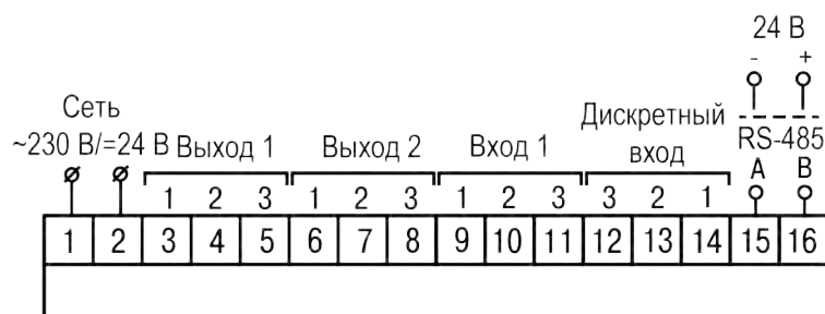
Рисунок 5.7 – Общая схема подключения TPM10–H
