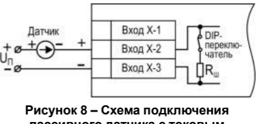
Рисунок 8 – Схема подключения пассивного датчика с токовым выходом 0...5 мА или 0(4)...20 мА
