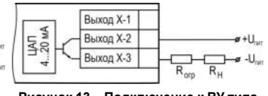
Рисунок 13 – Подключение к ВУ типа «И» с ограничивающим резистором
