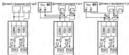
Рисунок 4 – Подключение к входам типа «ДС»
