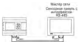
Рисунок 13 – Типовая схема подключения в режиме Slave
