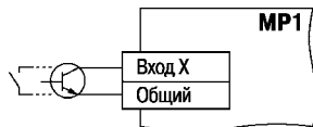
Рисунок Б.7 – Схема подключения транзисторного ключа или коммутирующего устройства ко входу MP1
